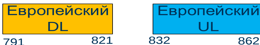
Рисунок 3.4 Частотный план для использования в полосе частот 790-862 МГц.
