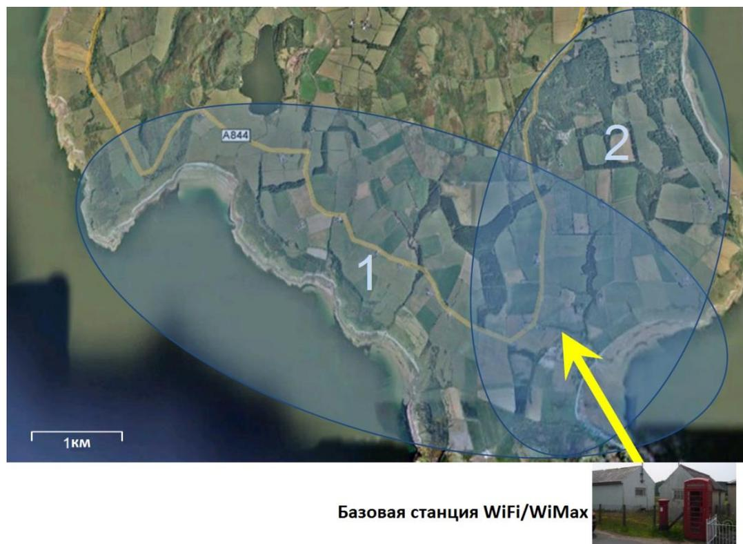
Рисунок 10 Зоны охвата базовых станций
