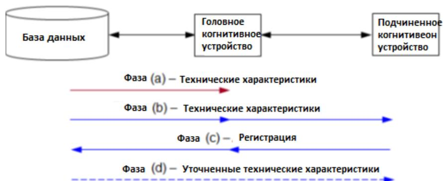
Рисунок 8 - Фазы взаимодействия подчиненного и головного когнитивных устройств
